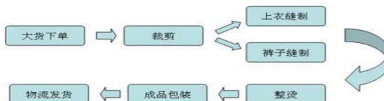
图 5-5 服装主要工艺流程图
