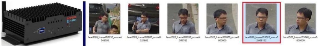
基于轻量级卷积神经网络模型的多路视频流人脸抓拍边缘设备
