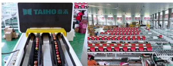
图为泰禾智能苹果全自动智能选果机在为丰海果业分选苹果
