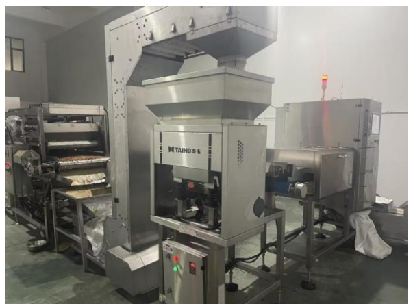
图为AI智选X光异物检测机在威辰食品进行松子加工作业
