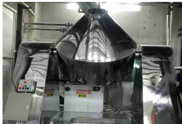
方案实施后使用的SZG-3000L型双锥干燥机
