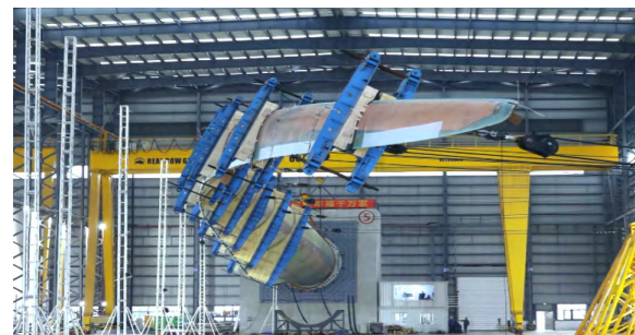
洛阳双瑞研发的叶轮直径达到 260 米的全球最长的 SR260 叶片，顺利通过静力测试，并在江苏盐城基地正式下线。
