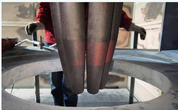
使用长寿命石墨电极柱开发的电弧炉
