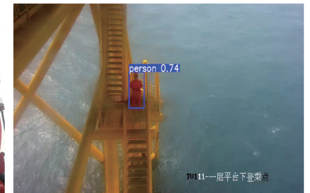
▲ 西安大唐海上风电-升压站登站口入侵检测
