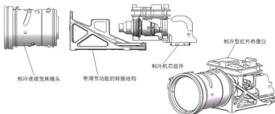
功能复杂一些的热像仪在机芯、镜头和结构件之外，还配有主控电路和若干功能模块（如可见光、北斗、显示屏等），因此也具备更为复杂的功能（如多光谱切换成像或融合成像、红外测温、坐标定位、拍照/录像/回放等），公司将这类热像仪通称为热像仪整机，简称整机。整机构成分解示意图如下：
