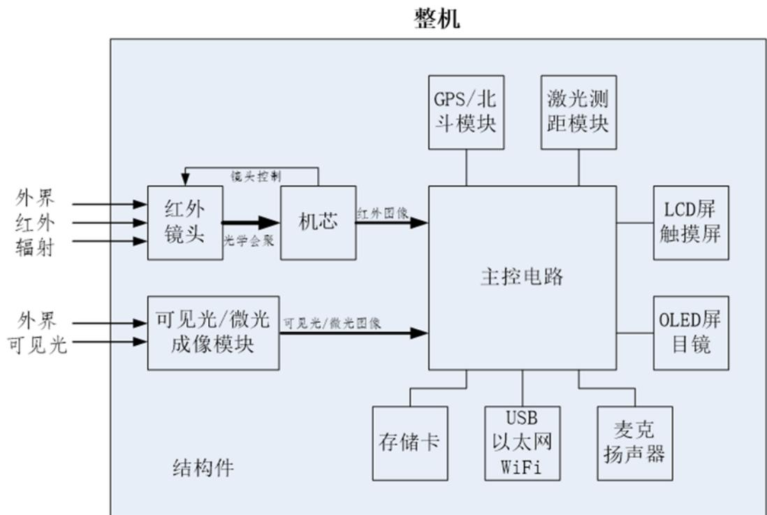
整机的红外图像来自机芯的输出信号，整机的成像性能主要取决于机芯和镜头的性能。整机的控制指挥中心是主控电路，包括机芯和镜头在内的其他硬件都是整机里的分立功能模块，在主控电路的调度下各自负责一部分功能。主控电路是典型的嵌入式系统平台，且往往是多处理器组
