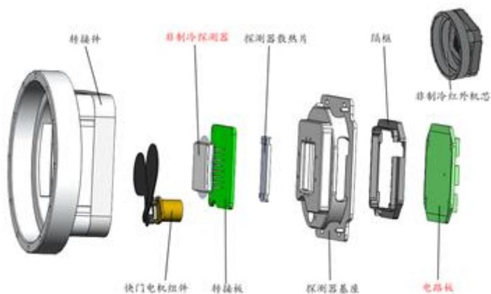
机芯中的探测器接收外界的电磁辐射信号，将其转换为电信号输出。硬件电路采集探测器输出的信号并进行处理（包括信号放大、模数转换、图像处理、视频编码等），最终输出标准格式的电子视频图像。探测器作为一种光电器件，其自身无法独立工作，需要依靠机芯的硬件电路才能正常工作。机芯的硬件电路一般分为三部分：探测器驱动及信号采集电路，对探测器进行驱动并
