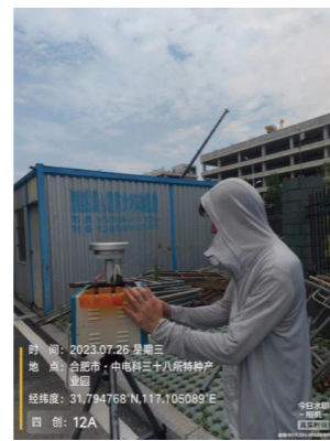
无组织废气检测现场采样图片
