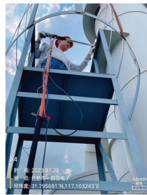
有组织废气检测现场采样图片
