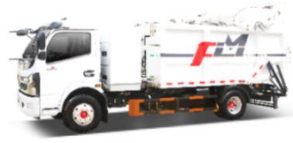
纯电动无泄漏压缩式垃圾车
