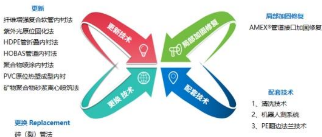
图 19 管道非开挖修复更新技术
