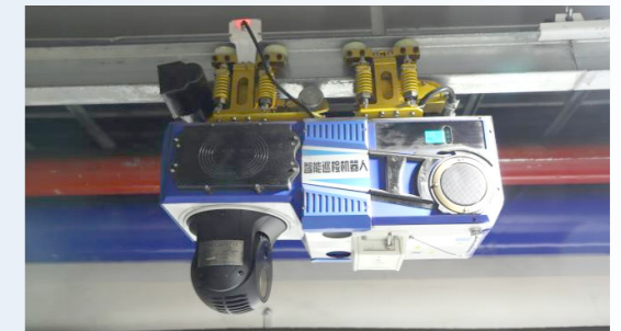
红墩子煤业智能巡检机器人
