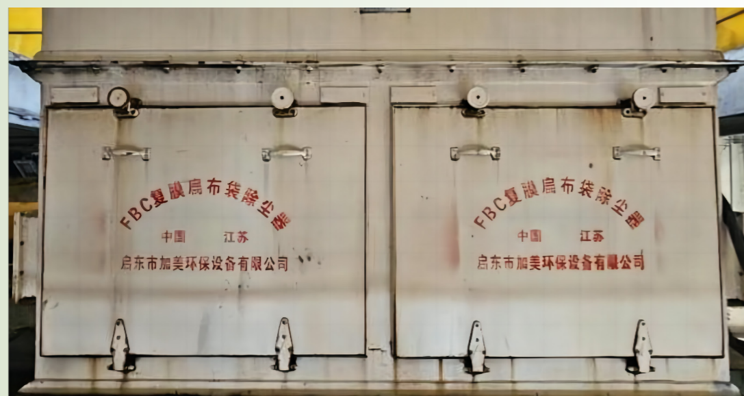
昊华精煤“智能化”FBC 自动清灰式复膜扁布袋除尘器
