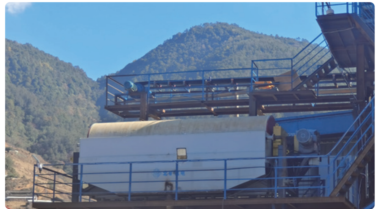
φ1.85×6 米超大型永磁筒式磁选机
