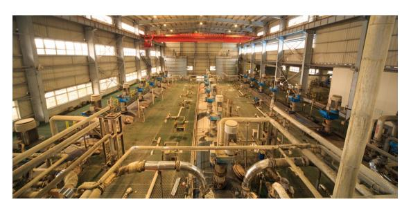
中金岭南丹霞冶炼厂氧压浸出炼锌工程锌氧压浸出车间
