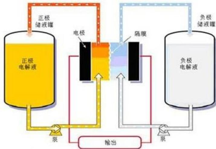
液流电池由电堆单元、电解液、电解液存储供给单元以及管理控制单元等部分构成。根据电化学反应中活性物质的不同，水系/混合液流电池又分为全钒液流电池、铁铬液流电池、锌基液流电池等。
