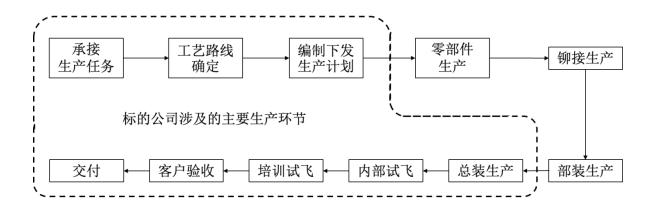
如上图,上市公司主要从事零部件生产、铆接生产和部装生产,标的公司自上市公司采购零部件,并继续进行总装生产等后续工序,共同组成直升机生产的关键核心
