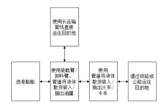
液体散货船舶到港后,工作人员使用卸料臂和自带动力的输送管道将液体 散货输送至油罐。根据目的地和运输需求不同,可选择使用专用输送管道将液 体散货装入火车或卡车通过铁路或公路运输,装入船舶通过水路运输,或直接 使用长距离运输管线运至目的地。
