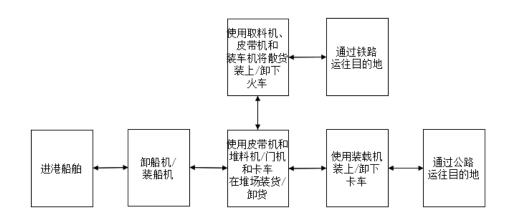
干散杂货船舶到港后,工作人员使用卸船机从船舶抓取干散杂货,然后通过皮带机和堆料机或门机和卡车的组合将干散杂货运至堆场。最后根据目的地和运输需求不同,可选择使用装载机将干散杂货装至卡车通过公路运输,使用装船机将干散杂货装至船舶通过水路运输,或使用取料机、皮带机等将干散杂货装至火车通过铁路运输。
