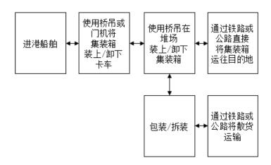
集装箱船舶到港后,工作人员通过桥吊或门机将集装箱从船舶上卸至卡车上,然后由卡车将集装箱运至堆场。最后根据目的地和运输需求不同,可以选择将集装箱直接通过水路或公路转运,或者在堆场拆装为散货后通过铁路或公路转运。
