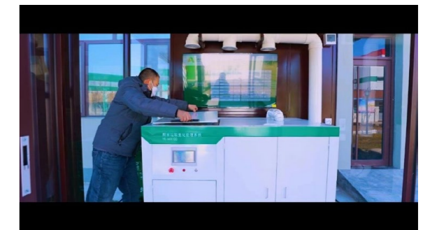
山东高速厨余垃圾处理系统
