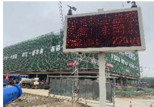
◎四公司 EOD 项目现场设置扬尘噪声风速仪
