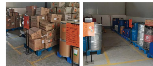
危险废物暂存间
