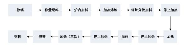
废旧铂网加工过程中的复杂关键点包括:(1)提纯环节:将旧铂网经过湿法 冶金工序后提纯到 99.95%纯度;减少贵金属杂质;(2)熔炼环节:按照一定标 准进行配料;减少铸锭的杂质和缩孔深度。
