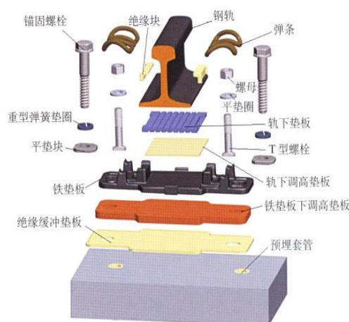
WJ-7型扣件组装零件图
