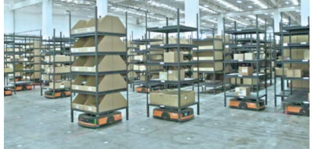
智能机器人在仓库内自动拣货运输
