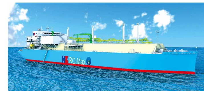
建造的LNG运输船为NO.96 L03+薄膜型船，总长239米，宽36米，可储存8万立方米液化天然气，是全球最大的浅水航道第四代LNG船
