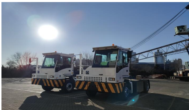
图：秦港股份60吨电力牵引车
