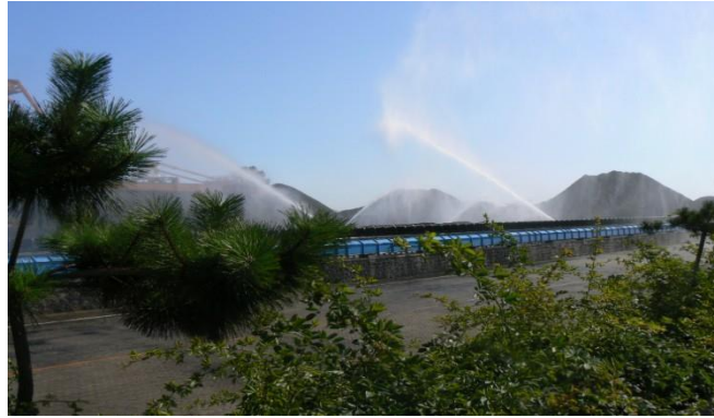
图：堆场正在进行洒水作业
