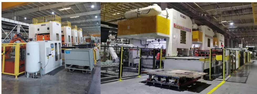
冲压连线是由压力机为核心，通过桁架机械手或者机器手（臂）自动传送金属材料，实现压力机对金属材料的自动冲压成型功能的自动化设备。冲压连线主要构成为压力机和机械手或机器手（臂），具有高可靠性、节能、节材等一系列优点，能够提高生产效率和产品质量。
