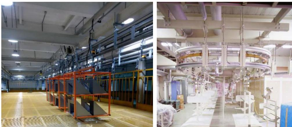
空中输送系统主要应用于空中立体场景，通过一整套自动化设备的复杂机械或电子动作独立实现生产过程中物料、零部件、产品的空中输送功能，是系统集成程度较高的一类空中自动化、信息化生产线产品。该系统结合信息化技术，做到物料的分类寄存，自动匹配主线产品调度对应物料，做到智能化调度匹配生产。该系统的应用能够解决传统货架或工装车寄存物料导致寄存调度困难、搬运及线边存放混乱、组装寻找匹配困难等问题，从而提高现场生产效率、改善企业生产环境。
