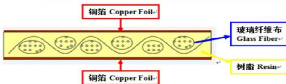
半固化片通常由玻璃纤维布（又称玻纤布）作为增强材料，在玻纤布表面均匀涂布特别调配的树脂后，经上胶烘干后制成，俗称胶片。半固化片的主要作用电路绝缘，并粘结固定铜箔电路。在半固化片的双面覆以电解铜箔，后经热压机高温高压，使半固化片粘结铜箔，并完全固化形成覆铜板。
