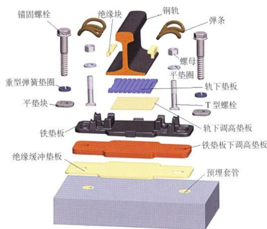
WJ-7型扣件组装零件图
