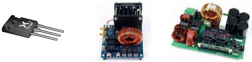
安世集团量产的 GaN FET 器件 安世 GaN FET 的半桥电路示意 安世 GaN FET 的图腾柱电路示意
