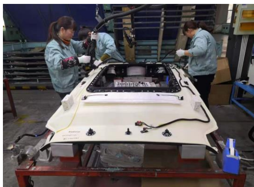
顶衬总成装配过程
