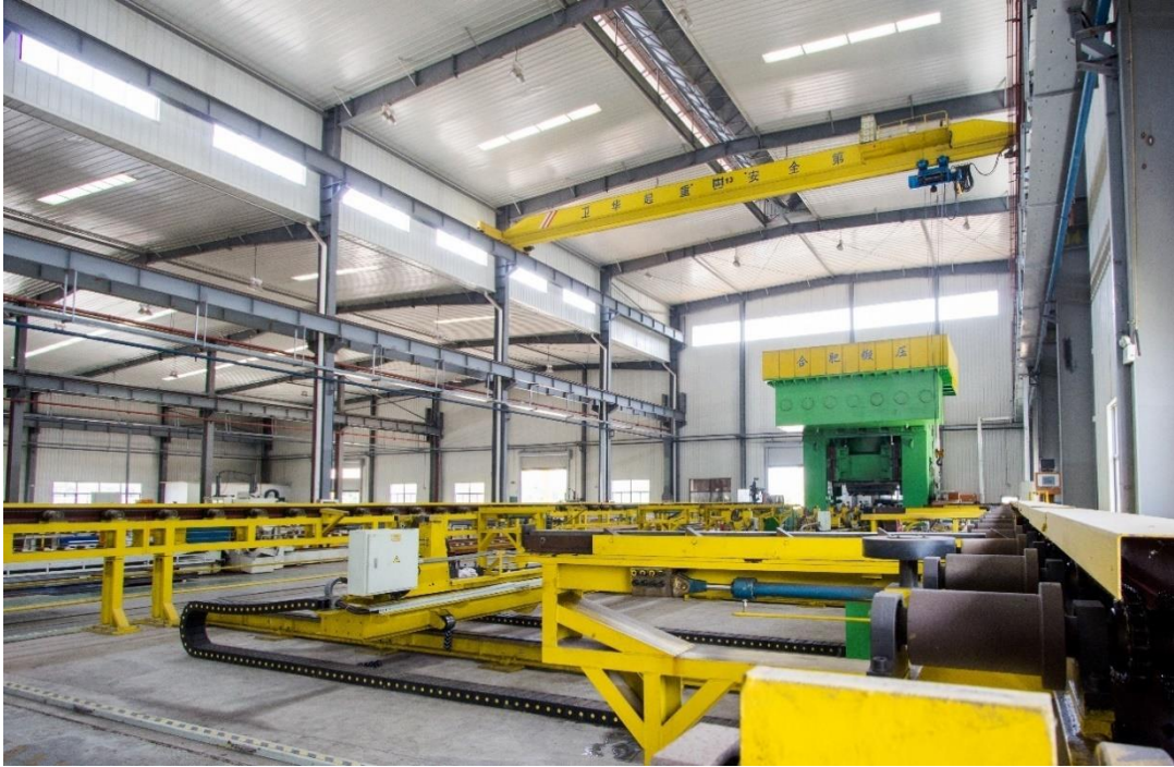
高铁道岔全自动液压机生产线
