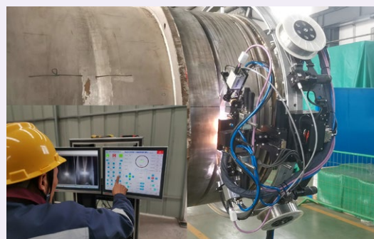
突破“卡脖子”技术！中国核建成功自主研制窄间隙氩弧焊接机器人
