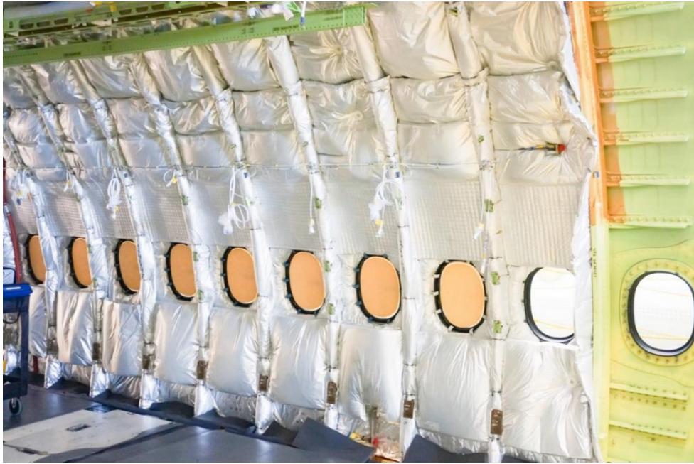
(图 装配隔音隔热毯的机舱)
