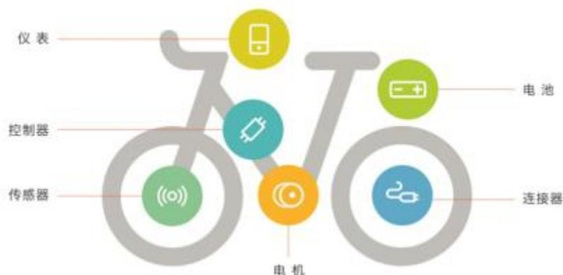
（注：上图只为列示电踏车电气系统主要部件，实际安装位置因不同型号而异）
