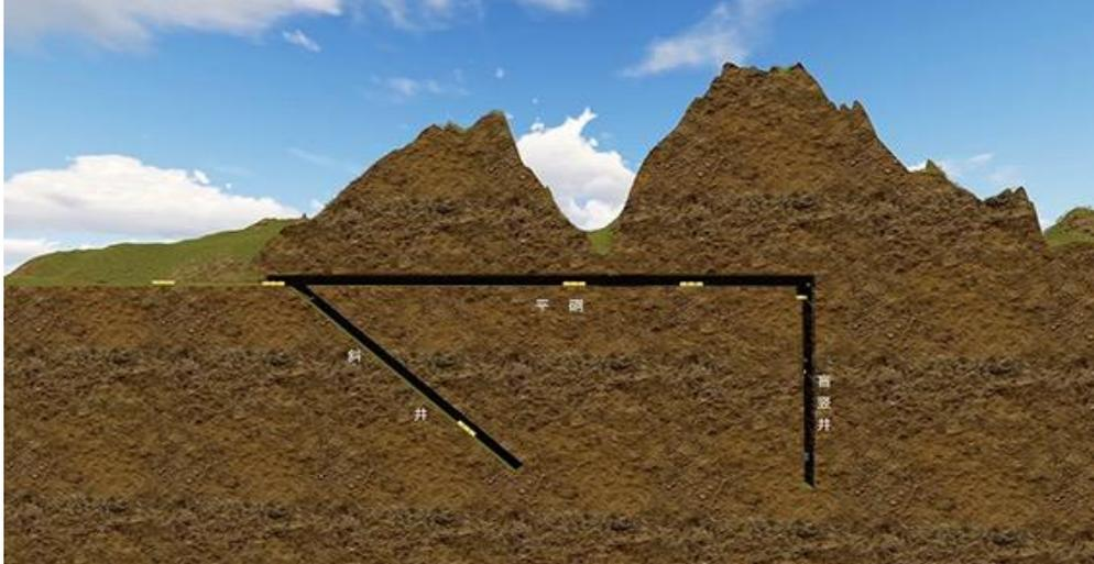
图 2： 萤石采矿开拓系统示意图
