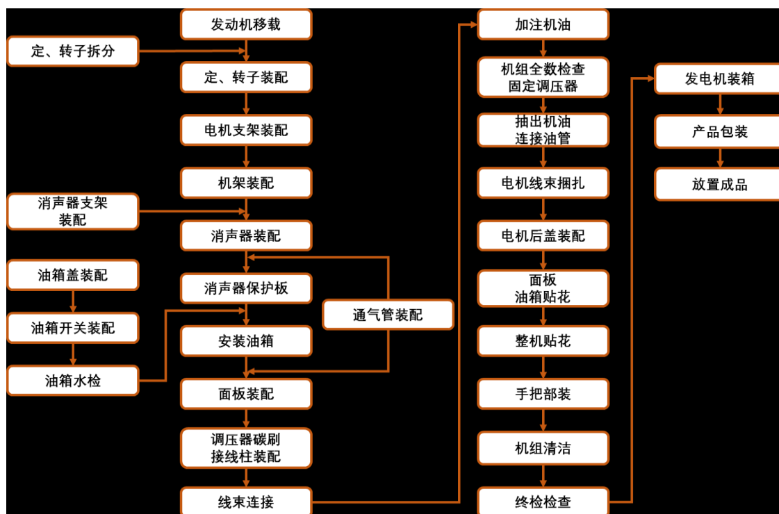
(3) 终端类产品生产工艺流程图
