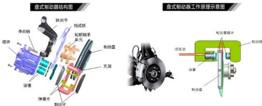
②后综合驻车盘式制动器总成
