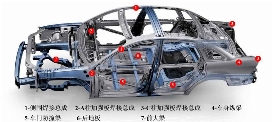
公司汽车车身零部件产品主要包括车门防撞梁、A 柱/C 柱加强板焊接总成、后地板、车身纵梁、侧围焊接总成、前大梁等。
