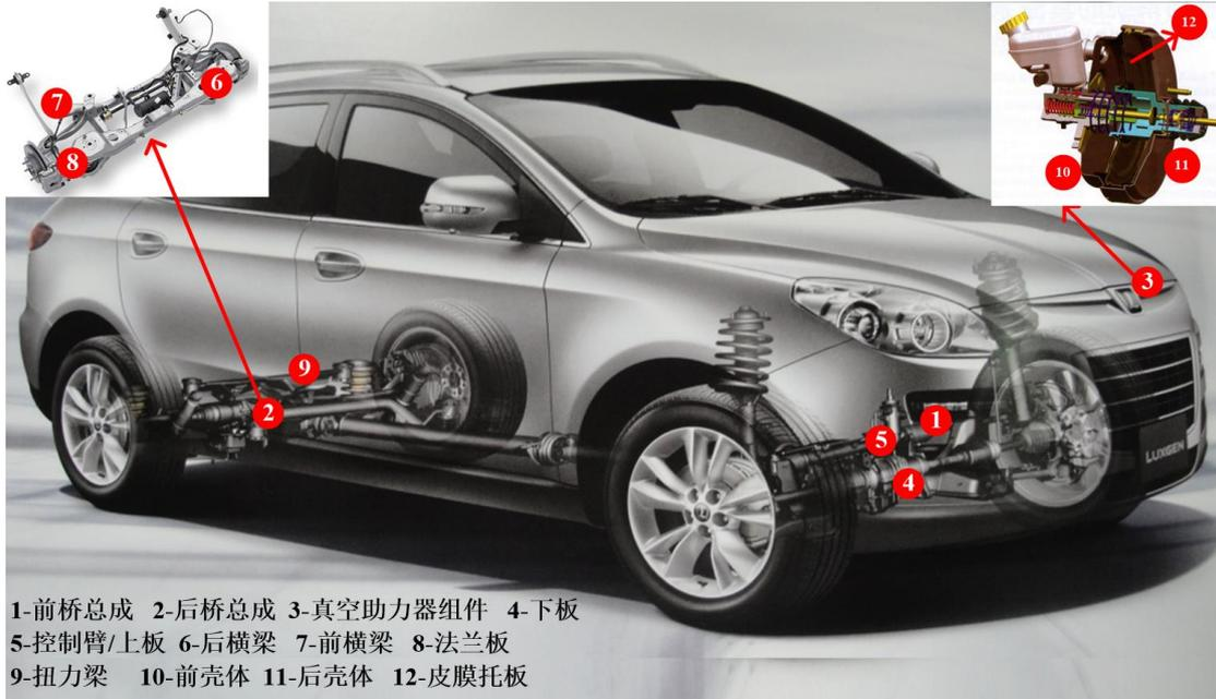
1-前桥总成 2-后桥总成 3-真空助力器组件 4-下板
