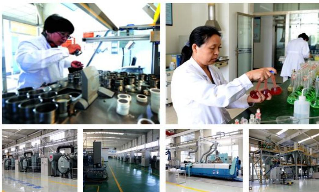
上两图为公司科研人员实验现场；下四图由左至右依次为烧结钕铁硼磁环中试线、钕钴永磁材料中试线、稀土镁合金中试线、PVC 稀土稳定剂中试线。
